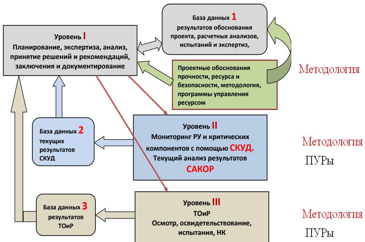
Рис. 2. Схема информационной системы управления ресурсом ИСУР
