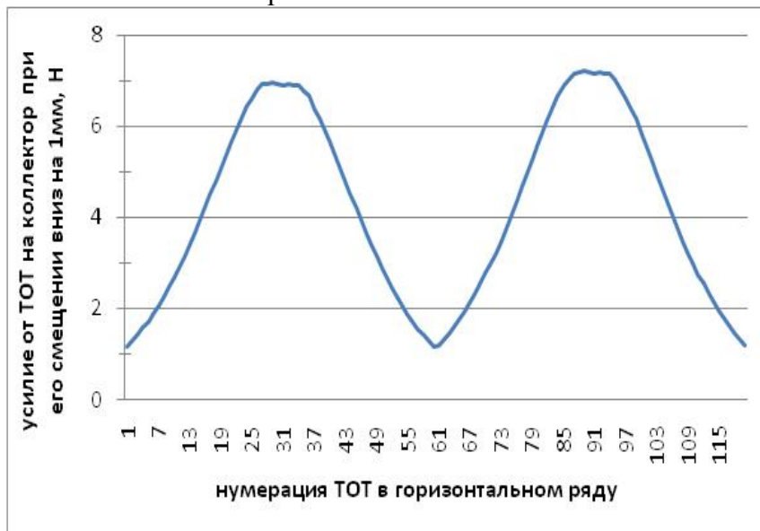
Рис. 3 Сопротивление ТОТ в горизонтальном ряду пучка ПГ при смещении на 1 мм коллектора ПГ
