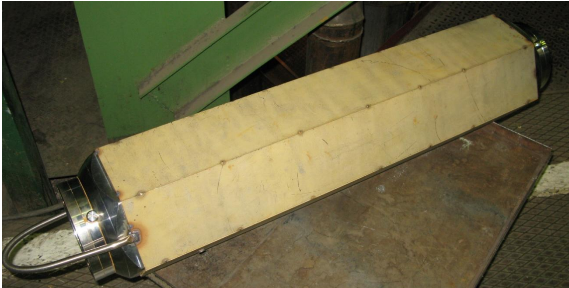
Рисунок 5 – Оснастка для испытаний АДФ
