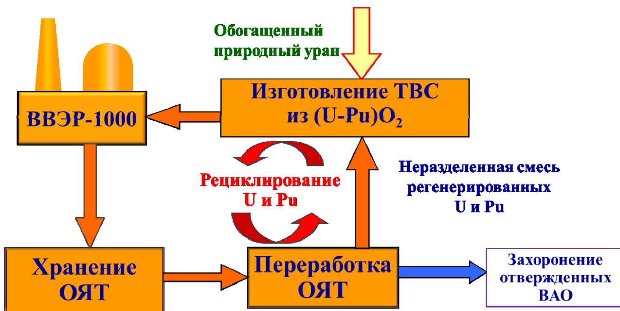
Схема рециклирования регенерированных урана и плутония в реакторе ВВЭР-1000 в виде РЕМИКС топлива /1/
