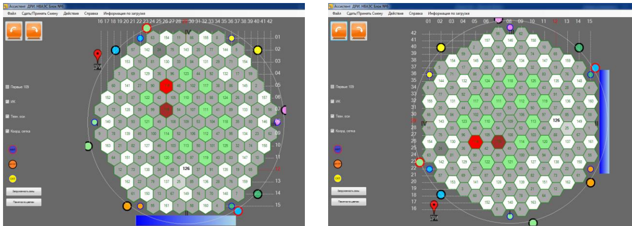
Рис. 5. Демонстрация возможности изменения ориентации картограммы в программе «Ассистент ДРИ» в режиме имитации загрузки блока №1 НВАЭС-2
